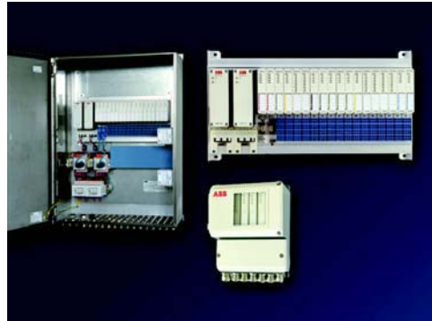
图 12. 本安型 S900 I/O 系统可安装在 1 类区和 2 类区，并且提供了诸如热切换及冗余 (选配) 等特有功能。
