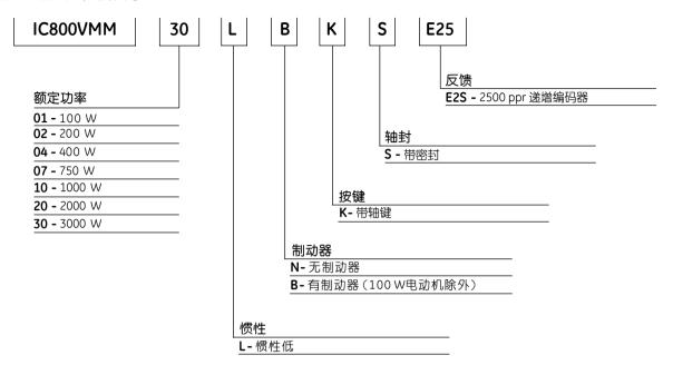
示例: IC800VMM30LBKSE25 为装有 2500 ppr 编码器、制动器、键槽和轴封的 3000 W 低惯性电动机。
