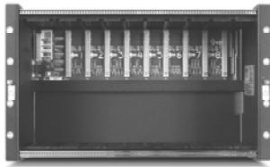
VME 扩展机架提供一系列配置来满足您不同应用的需求。从 5 槽标准机架和 9 槽标准机架到 17 槽 VME 综合机架，可以根据应用选择前安装或后安装。这些机架可用在 CPU、本地和远地 I/O 中，还接受所有的 IC697 电源模块。有了这些附件，两个机架可以工作在一个单独的电源上。GE Fanuc 提供安装简便的标准长度的电缆，并且根据您的应用提供布线信息。
