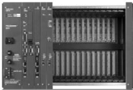
PACsystems RX7i 机架采用最新的 PLC 技术。机架能与先进的 PACsystems CPU 一起支持大功率的 PACsystems 电源。VME64 背板能提供高于现有基于 VME 总线的 4 倍带宽，达到更快的 I/O 吞吐量。VME64 背板支持所有的标准 VME 模块，包括系列 90-70 I/O 和 VMIC 模块。
