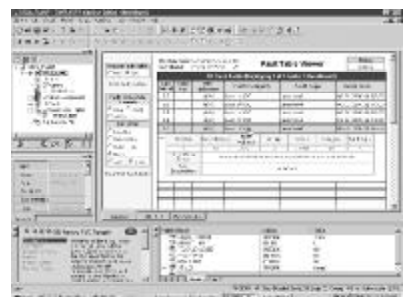
维护: 诊断工具, 如在线故障表和变量强制报告向你提供精确查找和诊断系统中事件的能力。
